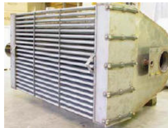
Moduł Grzewczy od strony płyty montażowej palnika
