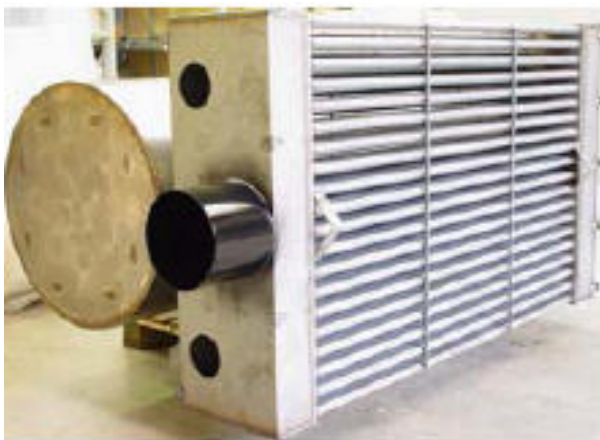
Moduł Grzewczy od strony wylotu spalin
