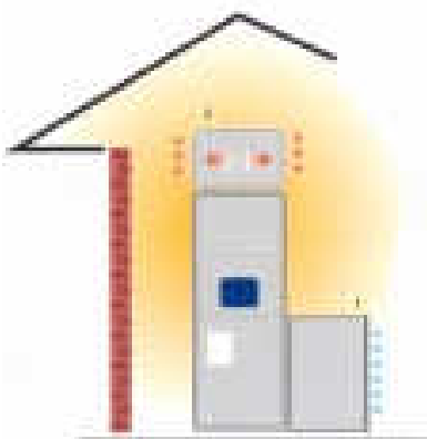
Nagrzewnica PK-A zainstalowana wewnątrz obiektu
